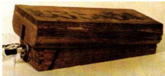
Протипіхотна міна ПМД в дерев'яному корпусі (фугасна)
